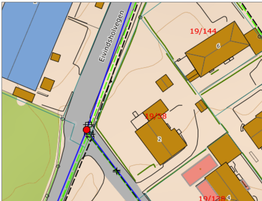
Figur 10: Utsnitt som viser vann-, avløps- og overvannsledninger i grunnen (fra kommunens karttjeneste)
